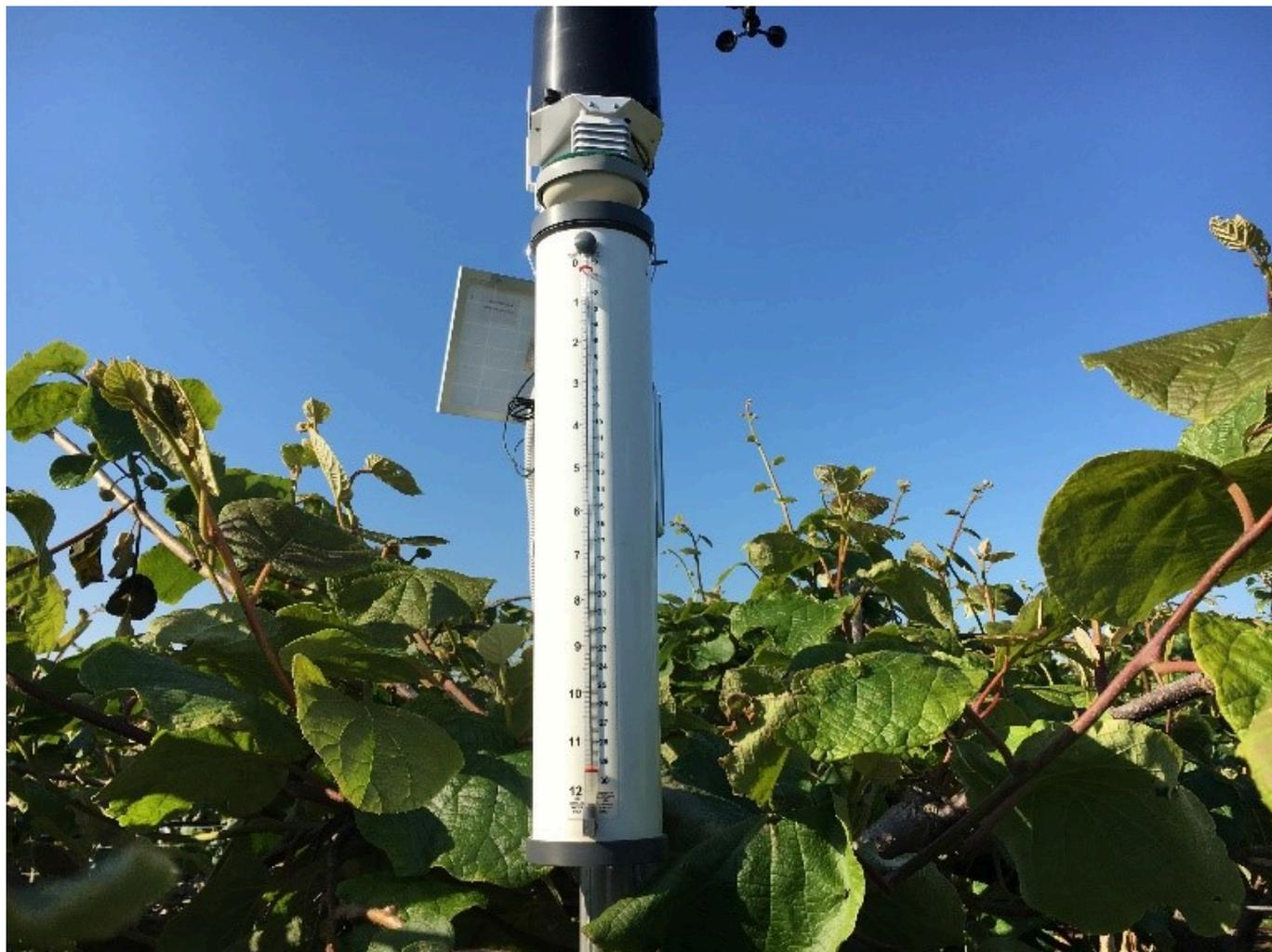
Foto 11. Atmometro per la stima dell'evapotraspirazione di riferimento (ET<sub>0</sub>), installato presso il sito 2, utile quando non si dispone del dato dalle capannine meteo del servizio Agrometeorologico Lucano.
