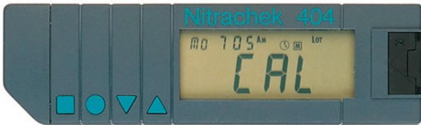
Figura 2. Nitrachek uno strumento di misura per la valutazione dei nitrati nel suolo.
