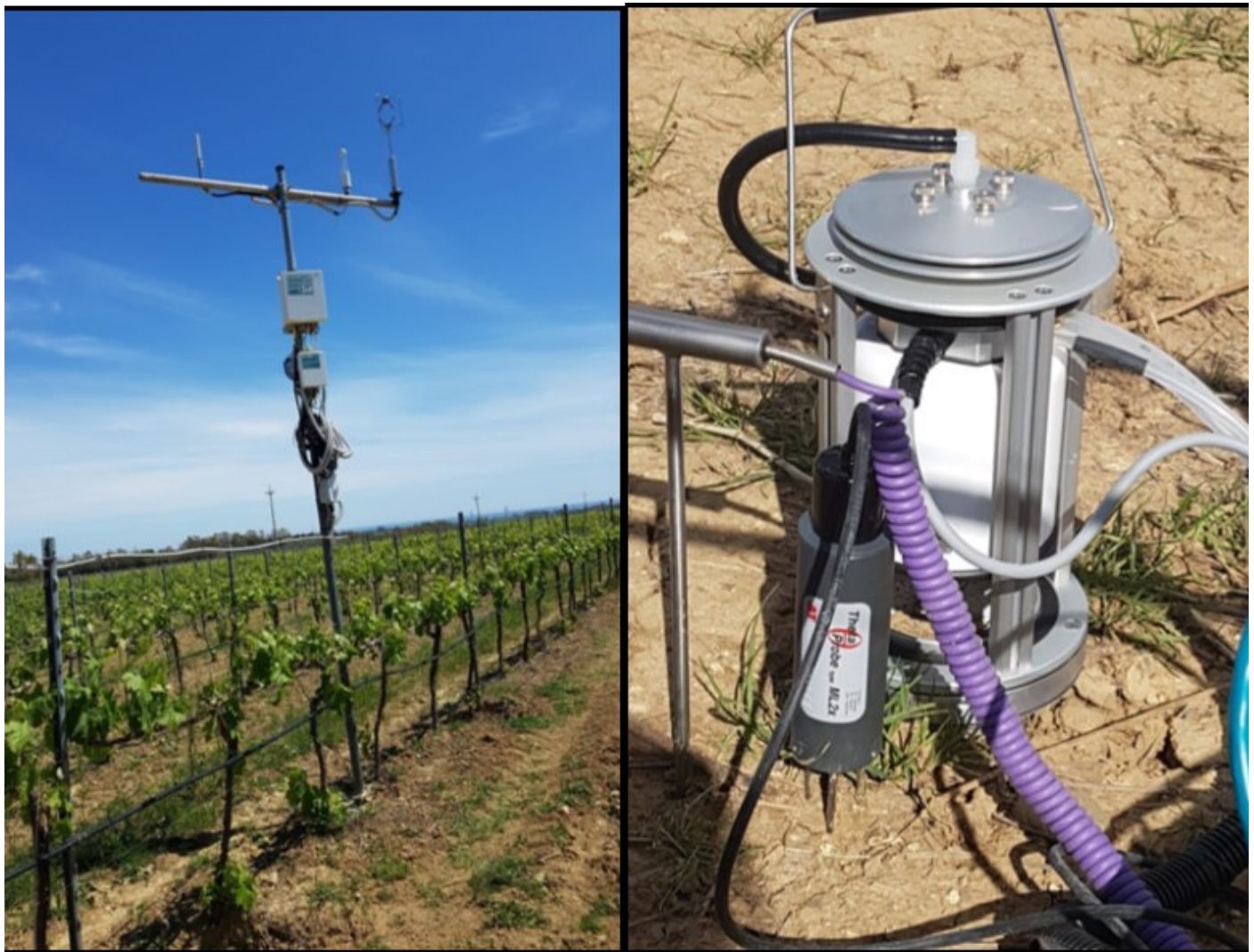
Figura 6. Stazione Eddy-covariance (a sinistra) e camera per la misura puntuale della respirazione del suolo integrata con sensore di umidità e temperatura del suolo. Le misure sono iniziate durante la primavera 2020.
