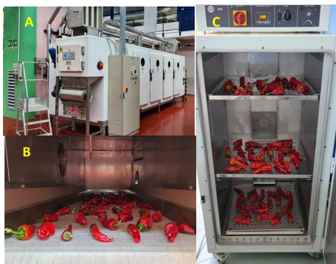
Figura 1- Essiccatore a ciclo continuo (A e B) e discontinuo (C).
