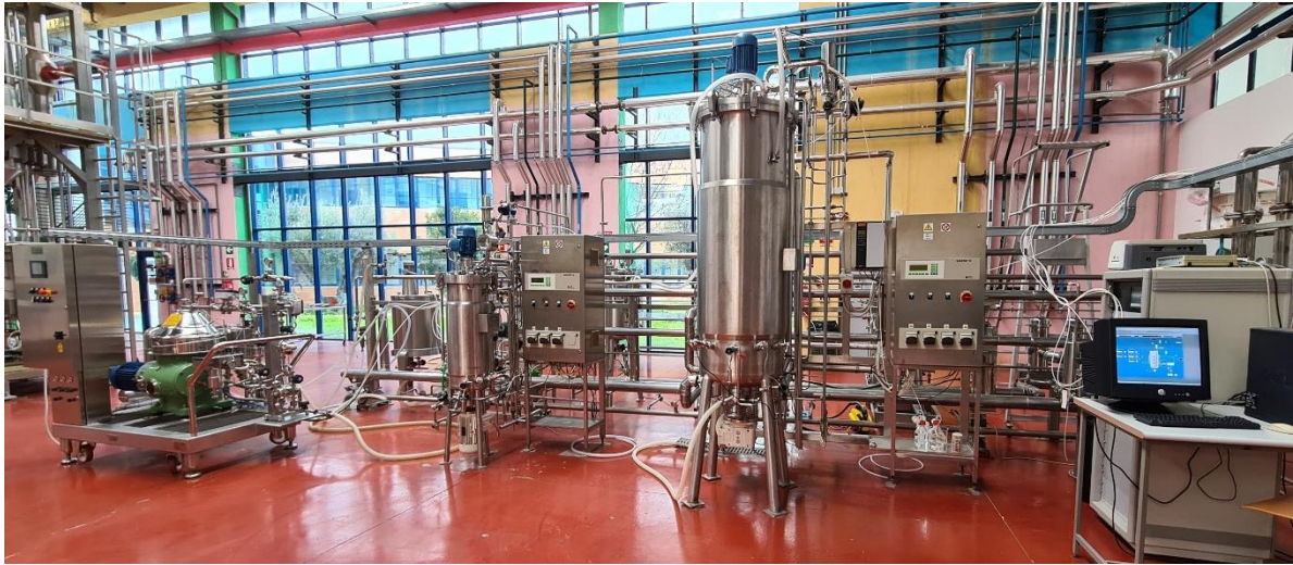
Figura 2 - Impianto di fermentazione per la produzione della biomassa dell'isolato ET-1 di Bacillus subtilis .
