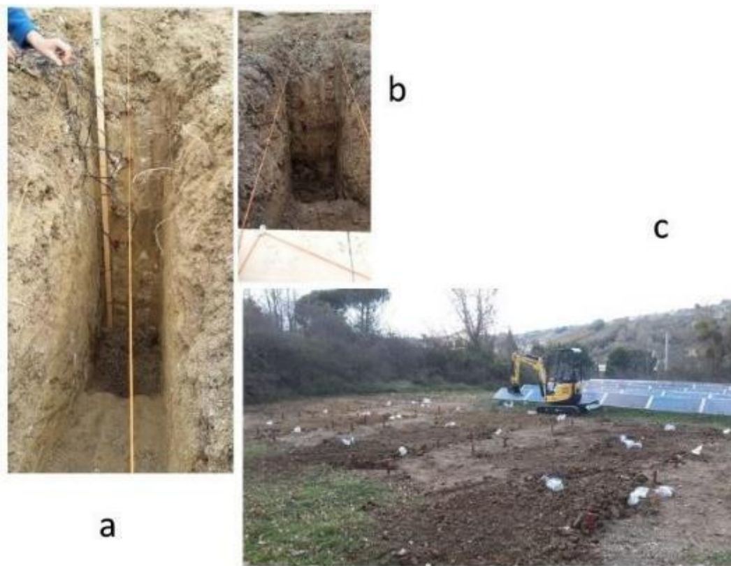
Figura 11 operazioni colturali: a e b vista delle trincee e posizionamento delle sonde capacitive per la misura dell'umidità del suolo a 4 profondità dal piano di campagna, c) copertura delle trincee ed impermeabilizzazione delle sonde capacitive per la misura dell'umidità del suolo
