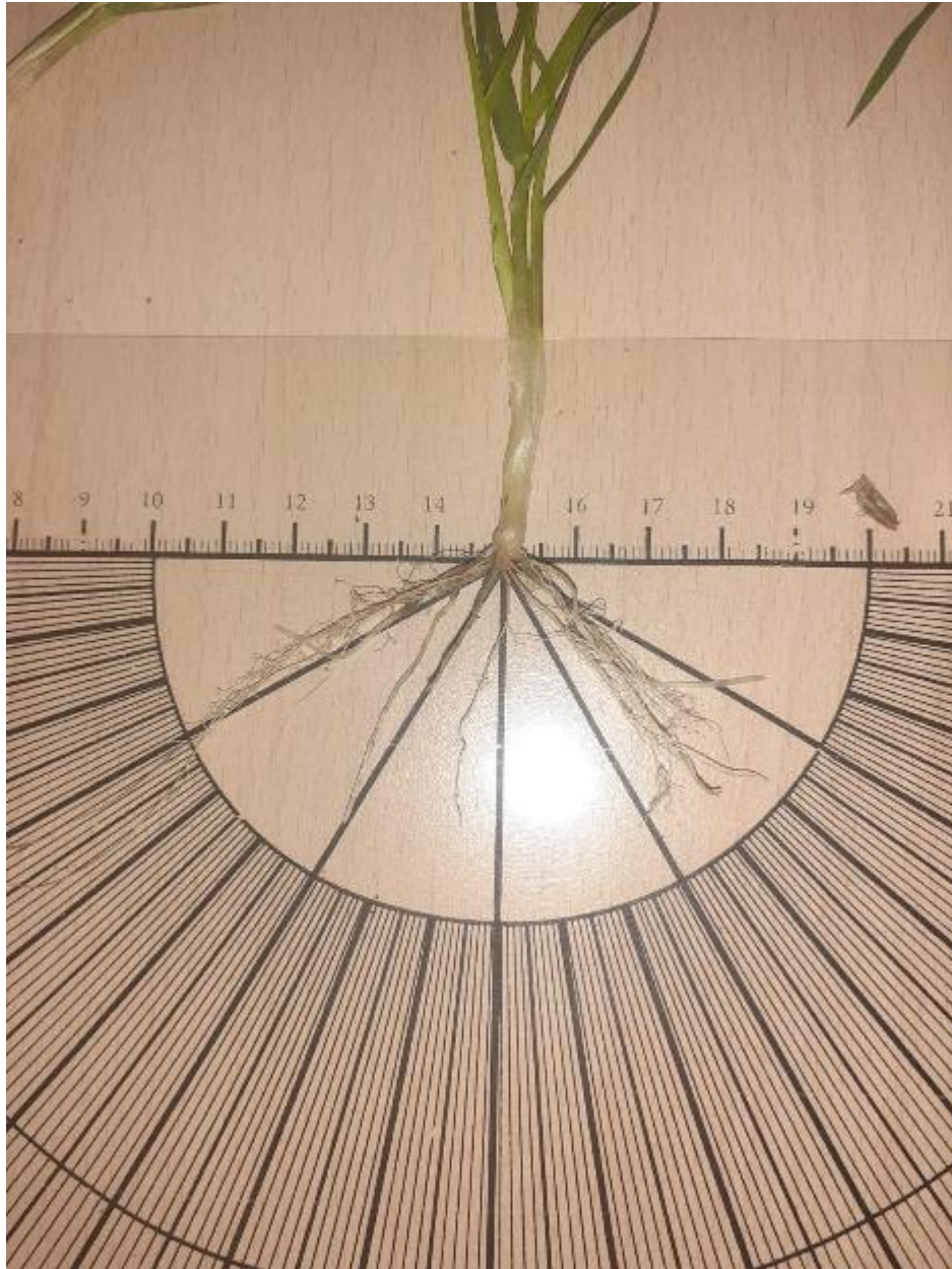
Figure 6 Fotografia di una pianta di frumento posizionata sulla lavagna graduata ( Shovelomic board) per la misura dell'angolo gravimetrico
