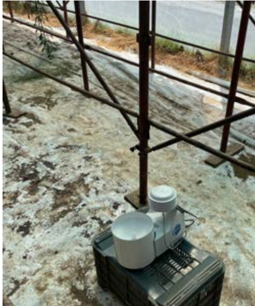
Centralina di monitoraggio di temperatura e umidità all'interno della serra per l'essiccazione del peperone rosso di Senise
