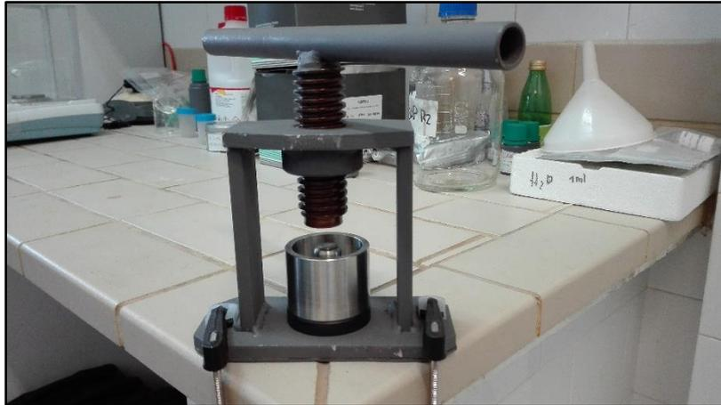
**Figura 1.** Sistema di estrazione a freddo per analisi di laboratorio su campioni di olive proposto da Diacron srl.
