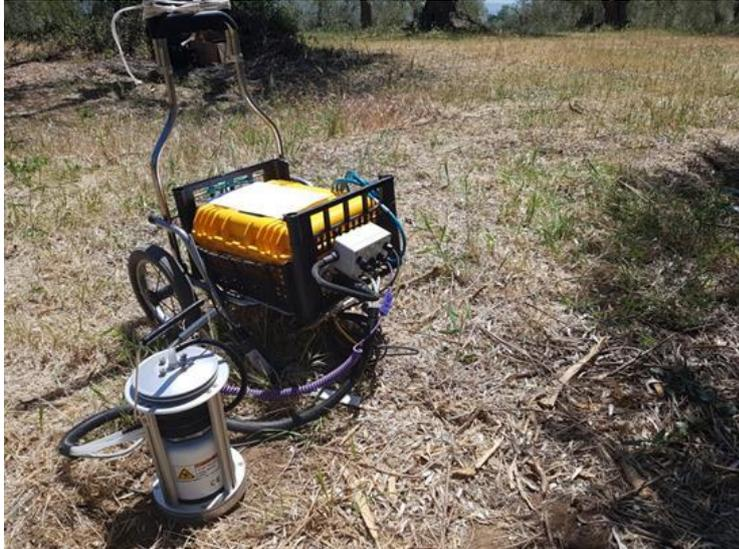
**La misura della respirazione del terreno rimane fra gli elementi del bilancio del carbonio più complesso da determinare. Nella foto fase della misura delle emissioni di CO<sub>2</sub> per respirazione del terreno mediante analizzatore portatile presso un oliveto non irriguo.**
