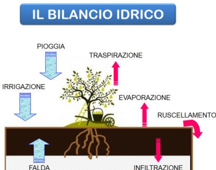
Figura 1. Modello di calcolo del bilancio idrico. In blu gli apporti di acqua e in rosso le perdite
