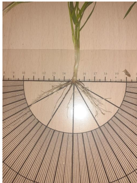
Figura 4. Fotografia di una pianta di frumento posizionata sulla lavagna graduata (Shovelomic board) per la misura dell'angolo gravimetrico
